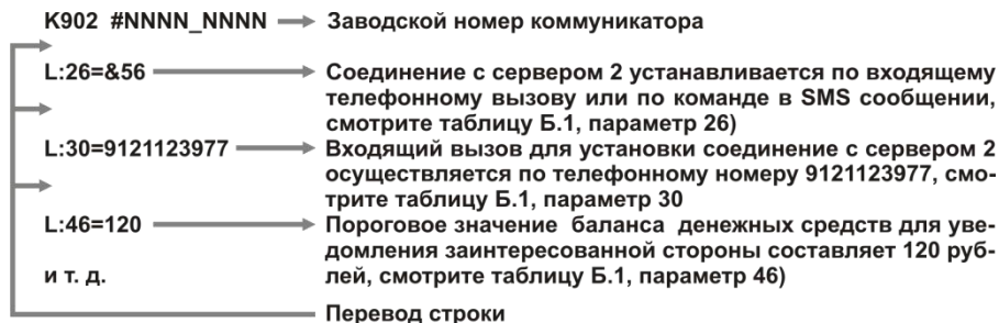
Рисунок 9 – Формат исходящего SMS на запрос о значениях параметров конфигурации
